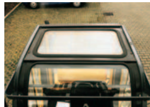
gebogener Stahl-Frontrahmen mit Stahl-Dachteil
