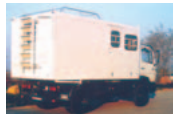
Sandwichaufbau für mobiles Labor auf MB 914AK.
