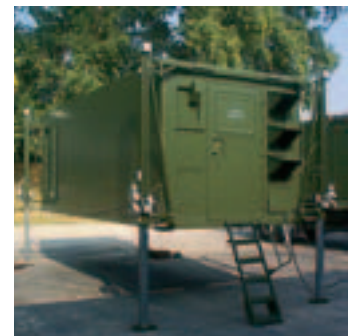
ISO-Container 20' x 8' x 8' mit angebautem Hubstützensystem.
