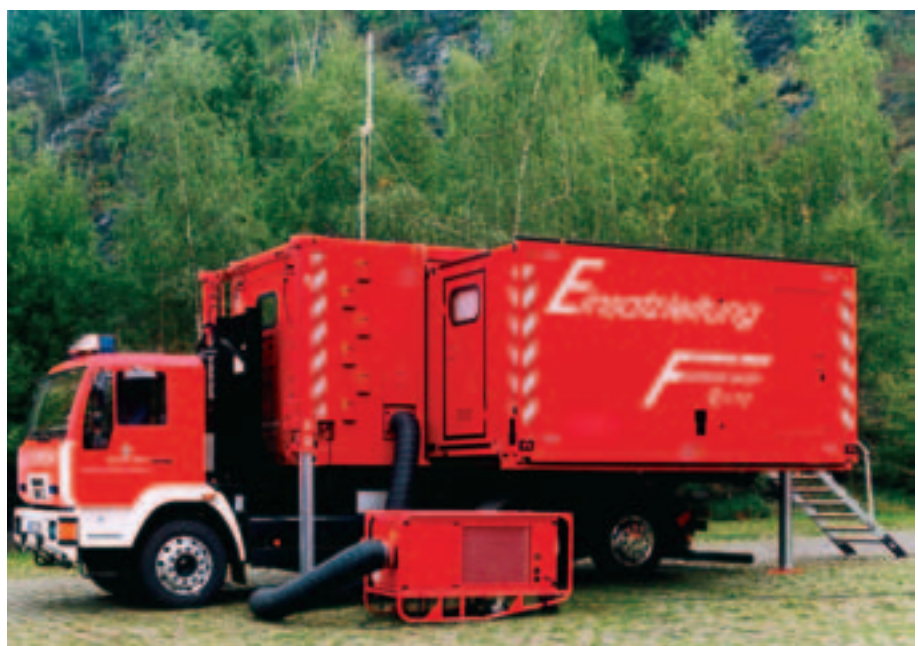
Container 1:3 erweiterbar (leichte Baureihe), z.B. für mobile Einsatzleitstellen
