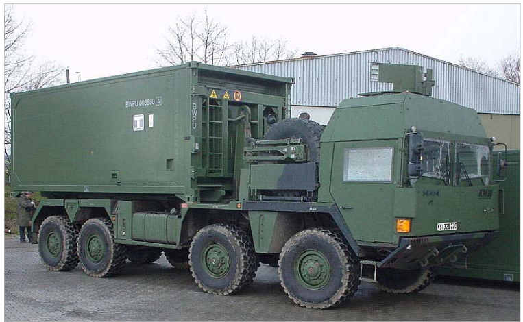
MuFuCo – Type "B" mit festen Seitenwänden
