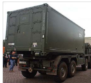
Ansicht Rückwand mit Eingangstür, Notausstieg und Serviceklappen
