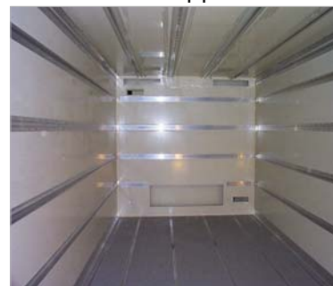
Innenansicht mit C-Schienen
