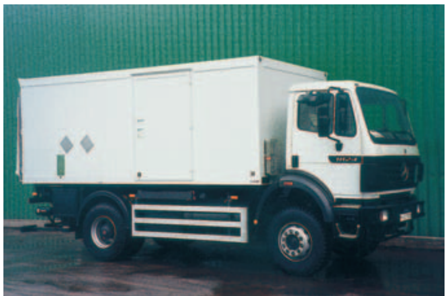
Aufbau nach GGVS für Munitionstransport auf MB 1824 AK.
